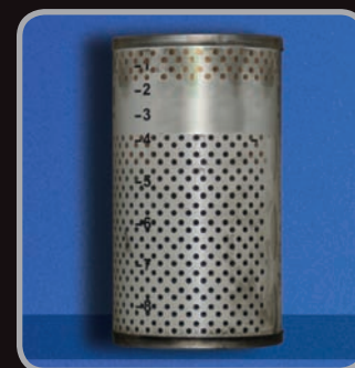
Diesel-Kraftstofffilter mit DK Premium nach 50.000 km
