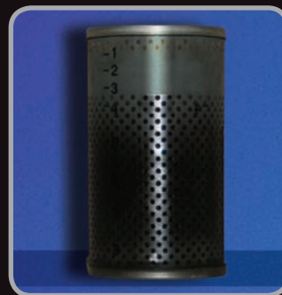
Diesel-Kraftstofffilter ohne DK Premium nach 20.000 km
